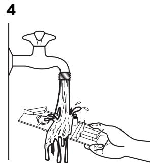
Um die Reinigung zu unterstützen, entfernen Sie auch das Oberteil des Pflegemittelfachs.
