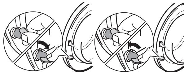
Per attivare questa protezione, ruotare in senso orario il bottoncino situato sul lato interno dell'oblò (senza premerlo) in modo che la scanalatura si trovi in posizione orizzontale. Se necessario, servirsi di una moneta.
