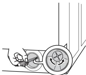
Utilizzare una matita per verificare se la ruota della pompa, posta dietro l'alloggiamento della pompa stessa, è libera di girare. (È normale che la ruota della pompa giri a scatti). Nel caso in cui la ruota della pompa non giri, si prega di contattare il centro di assistenza.
