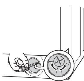
Prüfen Sie mit einem Bleistift, ob sich das Pumpenrad auf der Rückseite des Pumpengehäuses drehen lässt. (Es ist normal, dass sich das Pumpenrad ruckartig dreht.) Wenn sich das Pumpenrad nicht drehen lässt, wenden Sie sich an den Kundendienst.
