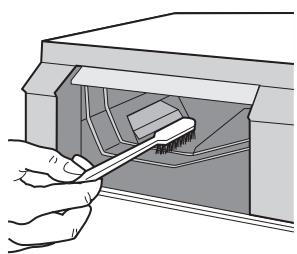
Verwenden Sie die gleiche Bürste zur Reinigung der Schubladenaufnahme und stellen Sie sicher, dass die Unter- und Oberseite gut gereinigt sind. Nach der Reinigung der Waschmittelschublade und der Schubladenaufnahme setzen Sie die Schublade wieder ein und lassen Sie ohne eingelegte Wäsche ein Spülprogramm laufen, um alle Reste wegzuwaschen.
