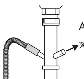
Wenn der Ablaufschlauch an einen Siphon unter einem Spülbecken angeschlossen wird, muss die Kunststoffmembran (A) entfernt werden. Falls Sie die Kunststoffmembran nicht entfernen, kann der Siphon durch Speisereste verstopfen.
