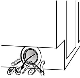
Drehen Sie den Pumpenflügel und entfernen Sie dabei vorhandene Fremdkörper.
