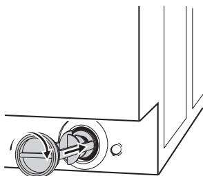
Riapplicare il tappo sul tubicino di scarico e riposizionarlo nel suo alloggiamento. Riavvitare bene la pompa.
