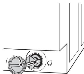
Replacez le bouchon sur le petit tuyau d'évacuation et remettez-le en place. Revissez le couvercle de la pompe.
