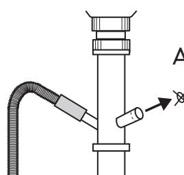
Si vous raccordez le tuyau de vidange à un embout du siphon sous l'évier, retirez la membrane en plastique (A). Si vous ne retirez pas toute la membrane, des résidus de lessive et des peluches risquent de boucher l'embout du tuyau de vidange.
