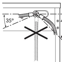
Ruotare il tubo di carico verso destra o verso sinistra a seconda delle necessità di installazione. Serrare correttamente il controdado per impedire perdite d'acqua.
