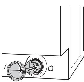
Stecken Sie die Verschlusskappe wieder auf den Notentleerungsschlauch und schieben Sie den Schlauch in das Gerät zurück. Schrauben Sie den Deckel der Pumpe wieder fest ein.
