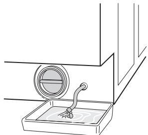
Ziehen Sie den Notentleerungsschlauch heraus (B), halten Sie das Ende in den Behälter und entfernen Sie die Abdeckkappe des Schlauchs.
