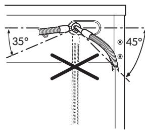
Der Zulaufschlauch kann passend zur Installation nach rechts oder links verlegt werden. Achten Sie darauf, dass die Ringmutter richtig angezogen ist, damit kein Wasser austreten kann.
