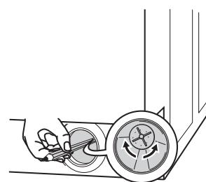
À l'aide d'un crayon, vérifiez que la roue de la pompe au fond du logement de la pompe peut tourner. (Il est normal que la roue de la pompe tourne par saccades). S'il n'est pas possible de faire tourner la roue de la pompe, contactez le service après-vente.
