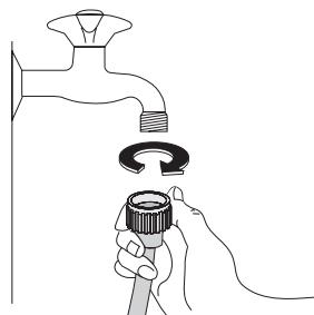
Raccordez le tuyau à un robinet fileté (3/4 po).
