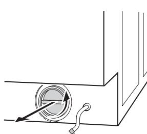
Quando l'acqua è fuoriuscita completamente, svitare e togliere il tappo della pompa (A). Tenere sempre a portata di mano uno straccio per asciugare l'acqua che potrebbe fuoriuscire nell'estrare la pompa.
