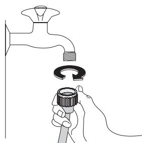
Schließen Sie den Schlauch an einen Wasserhahn mit 3/4"-Gewinde an.
