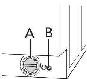
Stellen Sie einen geeigneten Behälter neben der Pumpe (A) bereit, um das Restwasser aus der Pumpe aufzufangen.
