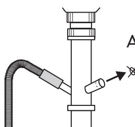
Se si collega il tubo di scarico ad un rubinetto posto sotto il lavello, togliere la membrana in plastica (A). In caso contrario, l'accumulo di residui di detersivo e lanugine degli indumenti può ostruire il sifone di scarico.
