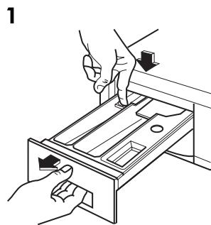
Entnehmen Sie die Schublade, indem Sie die Arretierung herunterdrücken und die Schublade herausziehen.
