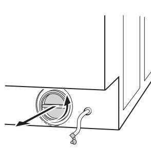
Quand l'eau ne s'écoule plus, dévissez le couvercle de la pompe (A) puis retirez-le. Conservez toujours à portée de main un chiffon pour essuyer l'eau qui s'écoule de la pompe lors du retrait du couvercle.
