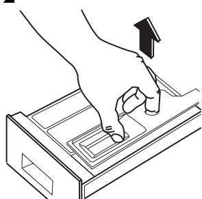
Pour un nettoyage plus facile, retirez également la partie supérieure du compartiment de l'additif.
