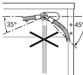
Le tuyau d'alimentation peut être orienté vers la gauche ou la droite, selon l'installation. Serrez correctement le contre-écrou pour éviter toute fuite d'eau.
