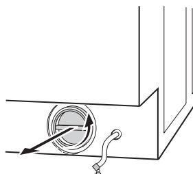
Wenn kein Wasser mehr abläuft, schrauben Sie den Deckel der Pumpe heraus (A) und nehmen Sie ihn ab. Halten Sie stets einen Lappen bereit, um austretendes Wasser beim Abnehmen des Deckels aufzuwischen.
