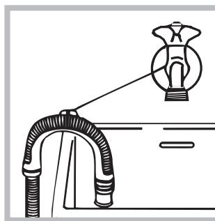
em alternativa, coloque na beira de um lavabo ou de uma banheira, prendendo na torneira a guia fornecida (veja a figura). A ponta solta do tubo de descarga não deve permanecer emergida na água.
