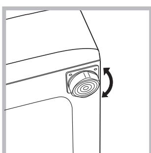
2. Yerleştirilecek zemin tam düz değilse çamaşır makinesinin vidalı ön ayaklarını sıkı ve gevşeterek dengeyi sağlayınız (bkz. şekil); eğim açısı, makinenin üst tezgahına göre 2° den fazla olmamalıdır.
