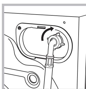
2. Su besleme hortumunu arka kısmının üst sağ köşesinde bulunan su girişine vidalayarak makineye bağlayınız (bkz. şekil).
