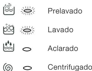
Nota: durante la fase de descarga se iluminará la luz testigo correspondiente a la fase de Centrifugado.
