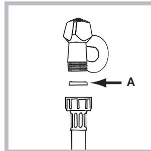
1. Illessze az A tömítést a vízbevezető cső végére és csavarozza fel a 3/4"-os külső menettel rendelkező hidegvíz csapra (lásd ábra). A csatlakoztatás előtt eresszen ki a csapból vizet addig, amíg a víz teljesen átlátszóvá nem válik.
