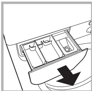
Para tirar a gaveta, puxe-a para fora (veja a figura). Lave-a com água corrente; esta limpeza deve ser efectuada frequentemente.
