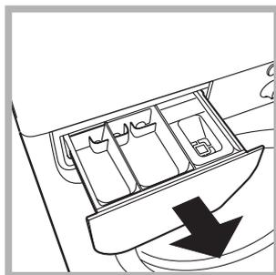
Extraiga el contenedor tirando hacia fuera (ver la figura). Lávelo debajo del agua corriente, esta limpieza se debe realizar frecuentemente.
