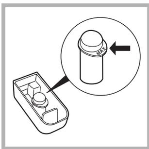
Introduceți sertarul adițional 4, aflat în dotare, în sertarul 1. Când dozați decolorantul nu depășiți nivelul „max” indicat pe pivotul central (vezi figura).
