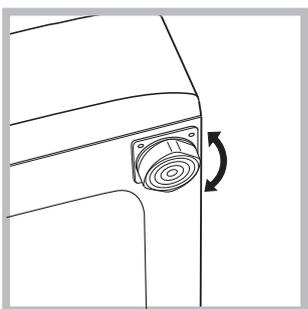
2. Dacă podeaua nu este perfect orizontală, compensați neregularitățile deșurubând sau înșurubând picioarele anterioare (vezi figura); unghiul de înclinare, măsurat pe planul de lucru, nu trebuie să depășească 2°.
