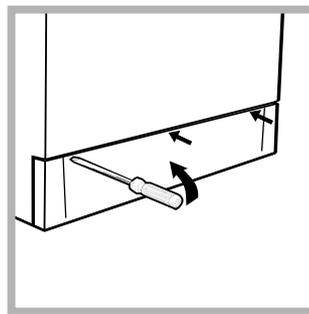
1. scoateți panoul de acoperire de pe latura anterioară a mașinii de spălat folosindu-vă de o șurubelniță (vezi figura):
