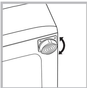
2. Si el piso no está perfectamente horizontal, compense las irregularidades desenroscando o enroscando los pies delanteros (véase la figura); el ángulo de inclinación medido sobre la superficie de trabajo, no debe superar los 2°.
