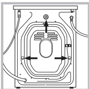
3. Scoateți cele 3 șuruburi de protecție pentru transport și cauciucul cu respectivul distanțator, situate în partea posterioară (vezi figura).
