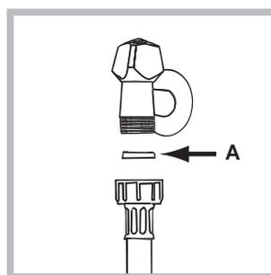
1. Introduceți garnitura A în extremitatea tubului de alimentare și înșurubați-l la un robinet de apă rece cu gura filetată de 1" gaz (vezi figura). Înainte de conectare, lăsați apa să curgă pentru a se limpezi.
