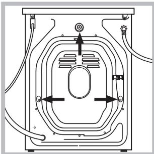
3. Távolítsa el a hátoldalon található, a szállításhoz felszerelt 4 védőcsavart, valamint a gumit a hozzá tartozó távtartóval (lásd ábra).
