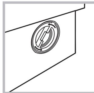
2. deșurubați capacul rotindu-l în sens invers (vezi figura): este normal să iasă puțină apă;
