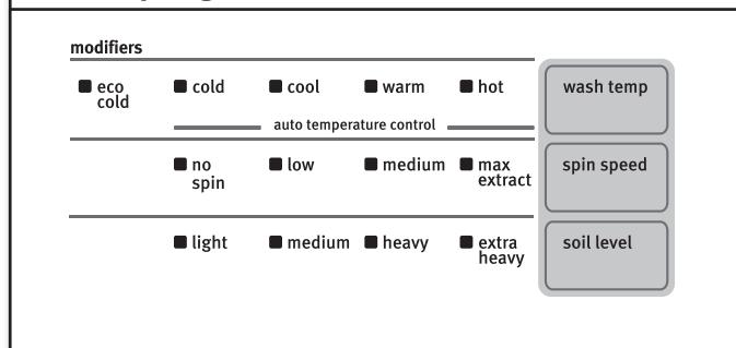
Après avoir sélectionné un programme, les réglages par défaut correspondant à ce programme s'allument. Appuyer sur les boutons de modificateurs du programme pour changer la Wash Temp (Température de lavage), la Spin Speed (Vitesse d'essorage) et Soil Level (Niveau de saleté) si désiré. Tous les réglages ne sont pas disponibles avec tous les programmes.
